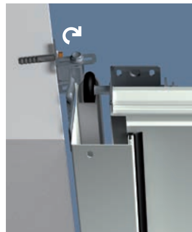
Montage bei schräger und unebener Seitenwand
