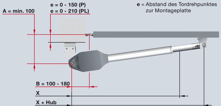
Für einen optimalen Torlauf sollte die Differenz zwischen A und B max. 40 mm betragen.
